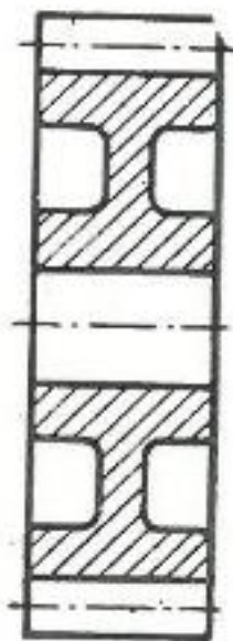
Rys. 2. Symetryczna budowa walcowego koła zębatego
