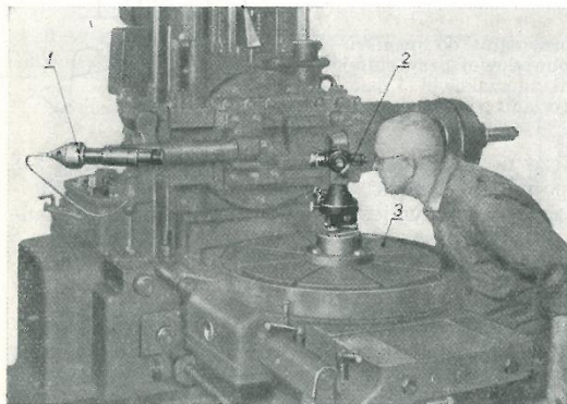
Rys. 110. Pomiar dokładności podziałki ślimacznicy w stole 3 frezarki obwodniowej przy pomocy teodolitu 2 i kolimatora 1
